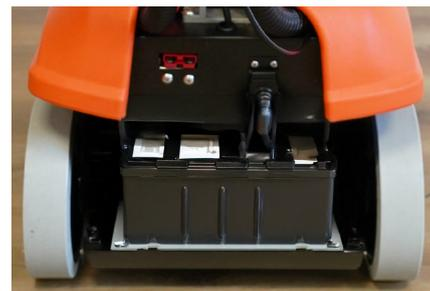
Système de contrôle à faible consommation d'énergie. Une charge complète peut faire fonctionner la machine pendant 1,5-2 heures avec une batterie au plomb standard de 24V/32AH.
