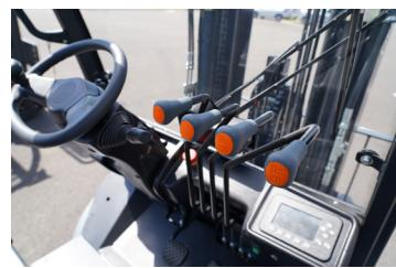
La gamme des chariots électriques de la série Q est équipée de série d'un nouveau volant ergonomique de diamètre réduit, équipé d'une boule de volant. Le chariot est également équipé d'un dispositif de commande de la vanne multidirectionnelle avant, permettant de rendre le travail plus confortable.
