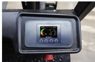
Le chariot élévateur est doté d'un nouvel écran LED ergonomique, grand format et d'une grande luminosité, qui assure un contrôle et une utilisation aisée, permettant d'obtenir des informations sur l'état de l'ensemble du chariot en temps réel.
