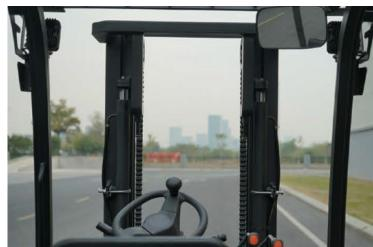
Les chariots de la série Q possèdent un mât à large visibilité offrant précision et confort d'utilisation à l'opérateur.
