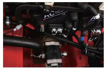
Le système de transmission utilise un essieu moteur horizontal doté d'un grand rapport de transmission. La batterie est installée en partie basse du châssis. Les chariots sont équipés d'un moteur à courant alternatif sans entretien, avec un empattement long (700mm) pour une meilleure stabilité.
