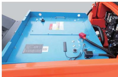
Les chariots de la série Q sont équipés de chargeurs ultra-rapide «minimum 100Ah», ce qui permet une charge complète de la batterie comprise entre 2 et 3 heures. 70% de la charge en seulement 45 minutes.
