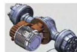
Le système d'entraînement utilise un essieu moteur horizontal en forme d'éventail disposé en parallèle avec un grand rapport de transmission. La batterie est située au bas du châssis, ce qui confère au chariot une bonne stabilité. Le moteur d'entraînement utilise un moteur à courant alternatif sans entretien. Empattement long (1700 mm), meilleure stabilité.
