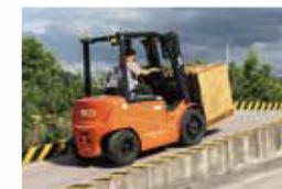
Le frein de stationnement à cliquet permet au chariot de rester sur une pente de 15 % sans problème de sécurité.
