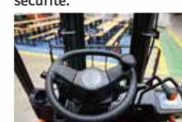
La conception en U du volant, le dispositif de commande de la vanne multivoie situé à l'avant rendent l'utilisation sans effort et confortable.
