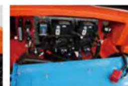
Le contrôleur est placé en hauteur pour faciliter la ventilation et l'entretien.
