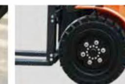
Les pneus de grand diamètre offrent de meilleures performances pour les applications extérieures, et une expérience de conduite confortable, en option pour les pneus pleins.
