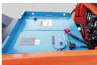
Le chargement rapide de la batterie se réalise en 2 à 3 heures (configuration standard : REMA/Anderson plugin). En option, le chargeur intelligent à haute fréquence, doté de la technologie de charge automobile, a un rendement supérieur à 95 %, ce qui est bien plus élevé que le rendement de 80 % du chargeur traditionnel à basse fréquence.
