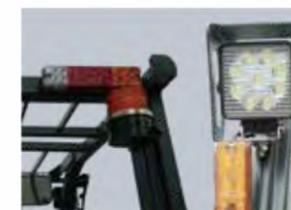
La sécurité des opérateurs est renforcée car le chariot élévateur est équipé de feux LED : phares, clignotants avant, feux de position arrière, feux d'avertissement.
