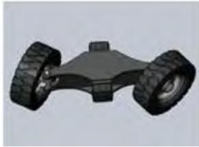
L'essieu directeur absorbe en effet les chocs pour protéger le système du véhicule et prolonger la durée de vie du chariot élévateur.
