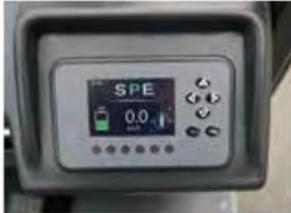
Il est équipé d'un écran d'affichage multifonctionnel avec code d'erreur, niveau des batteries et affichage des différents modes.
