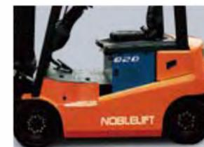
Le capot du véhicule et les petits panneaux latéraux gauche et droit sont formés par des plaques d'acier en une seule fois, ce qui est simple et décent et plus pratique à utiliser.
