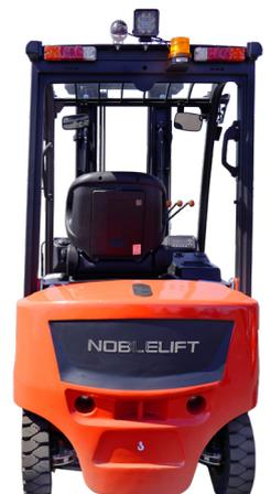
**C.** Les chariots de la série Q sont équipés de lampes LED de série, Blue spot, ports USB<sup>1</sup>, poignée arrière avec klaxon intégré<sup>2</sup>. Le tout étant d'offrir à l'opérateur le plus grand confort possible et une sécurité d'utilisation optimale.
