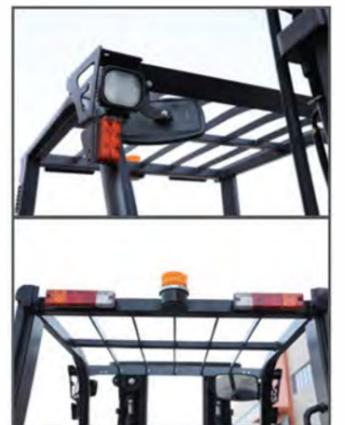
Le chariot élévateur est équipé de lampes LED standard : phares, feux de virage avant, feux combinés arrière, feux de brouillard. La lumière brillante et la faible consommation d'énergie vous permettent de travailler librement la nuit.
