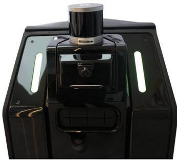
Capteurs de détection d'obstacles
