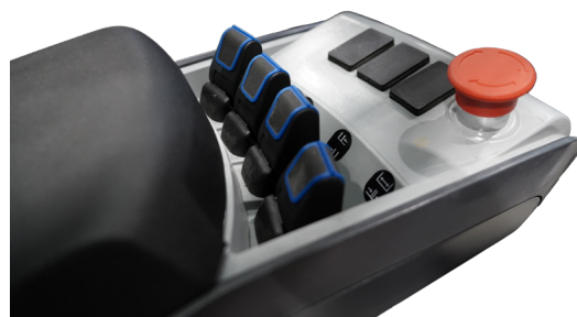
Kit Finger tip en option comprenant siège Grammer, valves Rexroth, joystick Elobau
